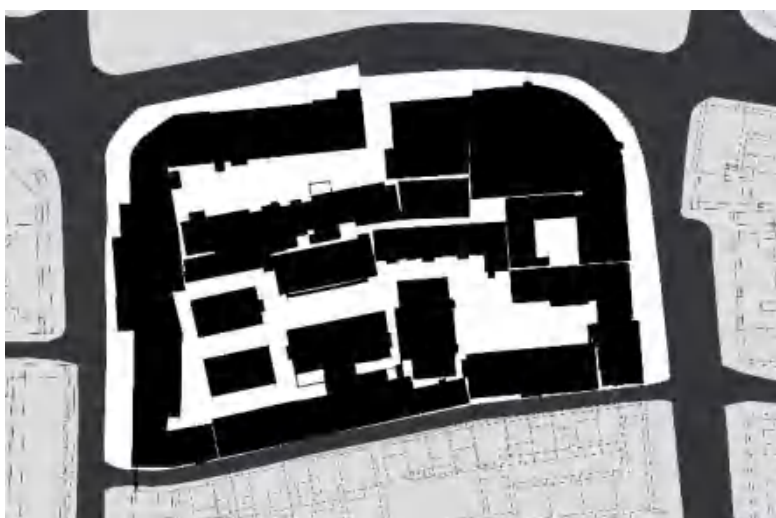
1、图底关系——片区内部与外部道路连通性较差，存在私搭乱建的情况，消防存在问题。
